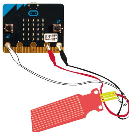
Fugtmåler, en ekstern komponent til BBC micro:bit
